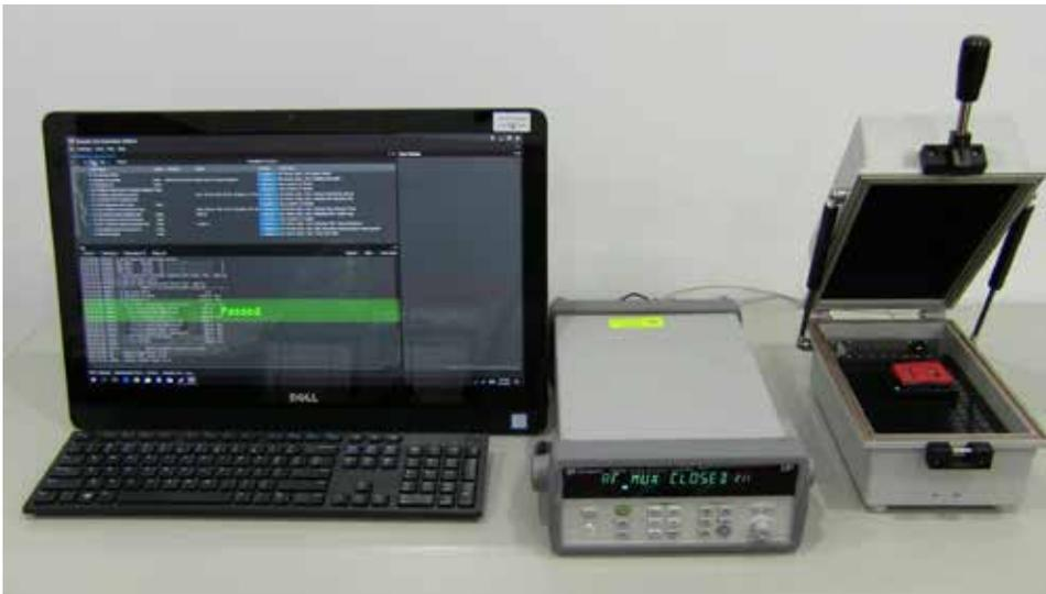
X8711A 中包括 34972A 数据采集单元、34999A 射频模块、基于是德科技测试自动化平台的测量套件、KS83301A BLE 4.2 信令模块和 KS83302A WLAN b/g/n 信令模块。用户需要提供系统 PC、屏蔽盒和射频电缆。
